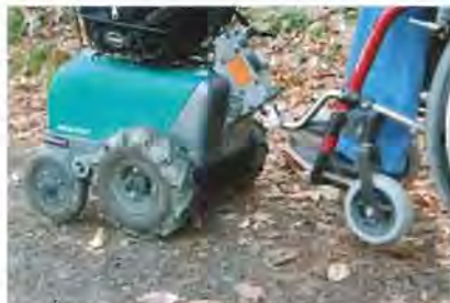
Gut für die Fahrt über unwegsames Gelände: Viel Bodenfreiheit für die Lenkräder
